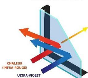
Un verre traité avec VITRO'REFLECT® bloque 99.9% des UV et jusqu'à 85% des IR
